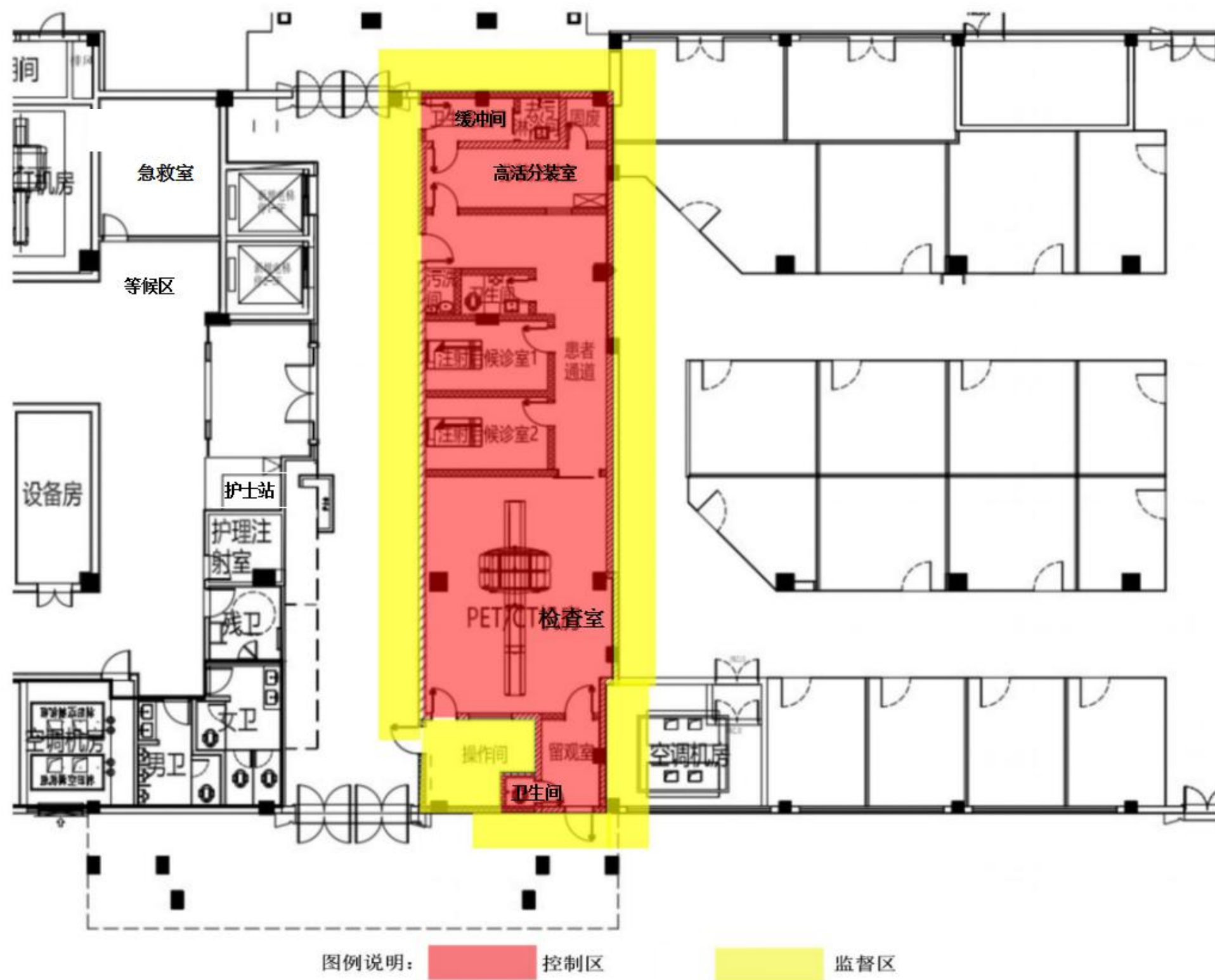
图 3-3 核医学科 PET/CT 工作场所平面分区示意图
